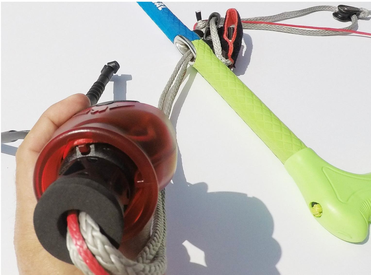
La cordelette du chicken loop est un peu grande ; vous devez alors faire tourner le T Bone (extrémité du chicken loop) plusieurs fois dans le sens des aiguilles d'une montre, jusqu'à ce que le chicken loop rentre complètement dans le corps du largueur :
